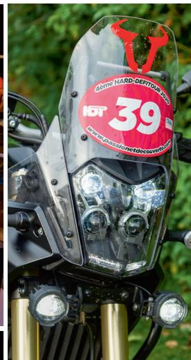
◀ L'éclairage à led de la Ténéré 700 est déjà efficace. Pour gagner encore en largeur d'éclairage, on a ajouté des antibrouillards additionnels SW Motech au prix de 343,43 €. ▼ Les protège-mains, de la même marque, sont composés d'une barre en métal très solide (137,37 €).
